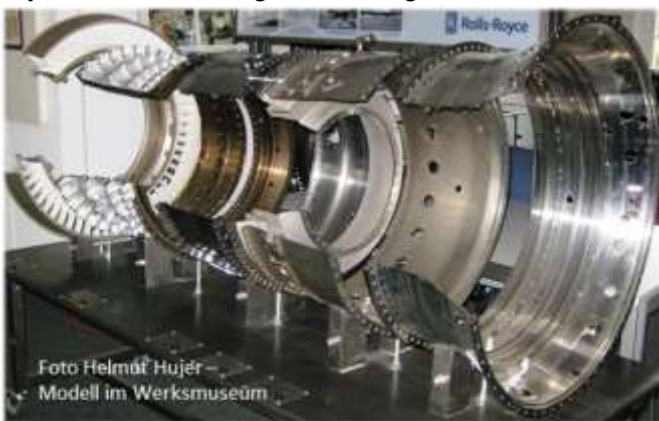
Von 1995 bis 2010 gefertigte Gehäusebauteile BR710/BR715
