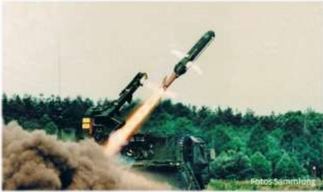
Drohnenstart vom Launcher mittels Feststoff-Booster und Landung mit Fallschirm und Luftkissen
